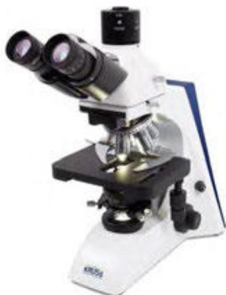
Mikroskop für Blutuntersuchung nach Enderlein mit Köhler-Beleuchtung und Foto- & Videotubus;
